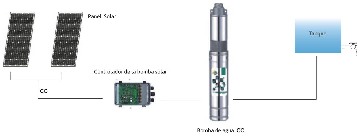
**Esquema del sistema de bombeo de agua solar**
